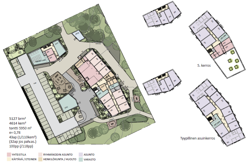
Kuva 17. Viitesuunnitelman ote. Vaihtoehdon 2 asemapiirros ja pohjakuvia. MY-arkkitehdit 2023
