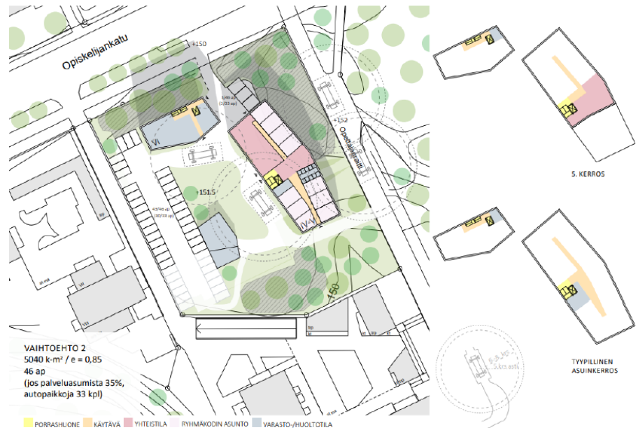
Kuva 15. Aloitusvaiheen vaihtoehdon 2 asemapiirros ja asuinkerroksen pohjaesimerkkejä. MY-arkkitehdit 2021
